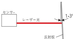
図 27: 反射板の取り付け
